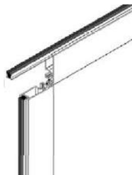
3. Placer la toile **(A)** sur le cadre (la toile doit dépasser légèrement de l'emplacement pour fixer le joint).
